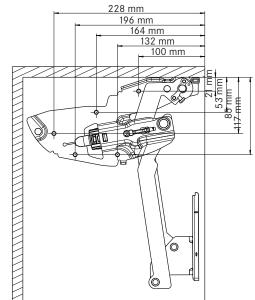
Bohrpositionen (Beschlag mit Positionierbolzen)
